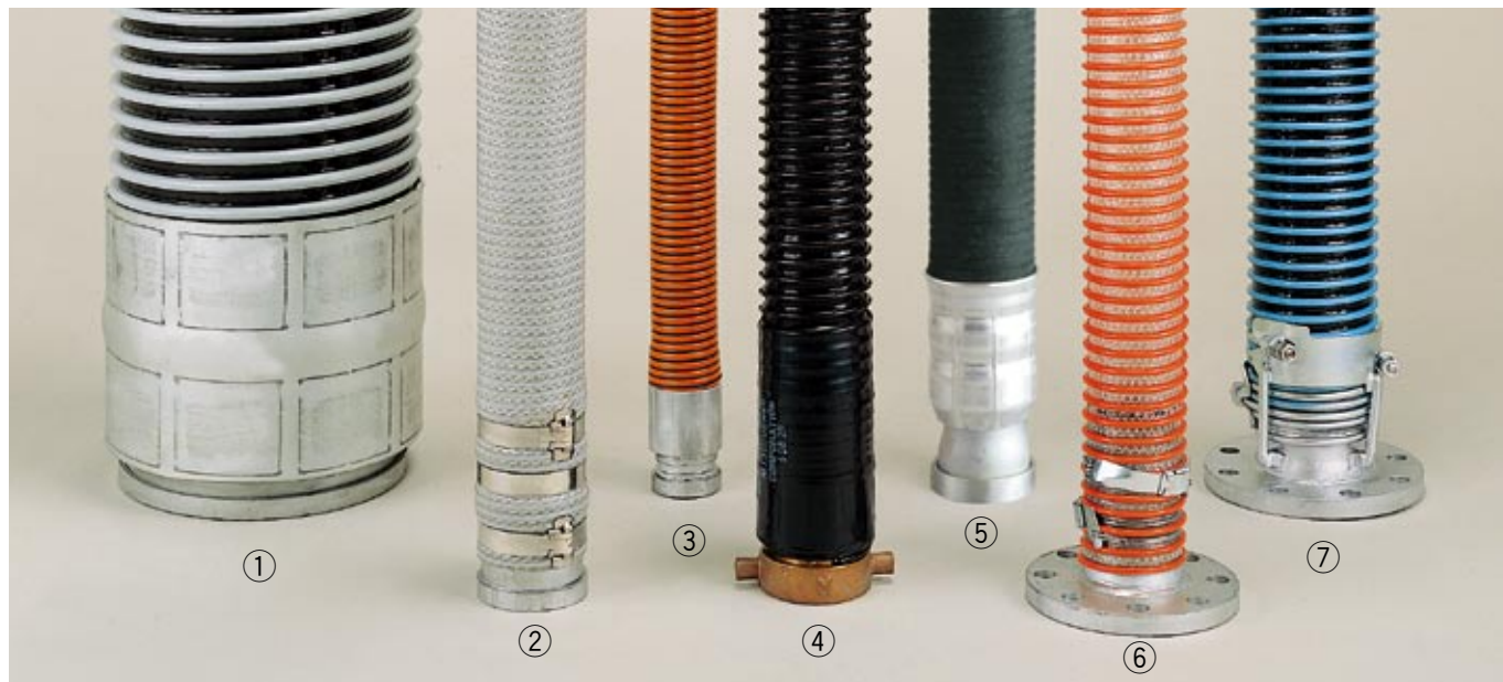
ホース取付け例 ①外筒加締 ②フープバンド締め ③内筒拡大外筒加締 ④ローリー用カップリング&アルミ加締 ⑤外筒加締(抜け止め) ⑥SEバンド締め ⑦トータクパワーバンド締め(抜け止め)
